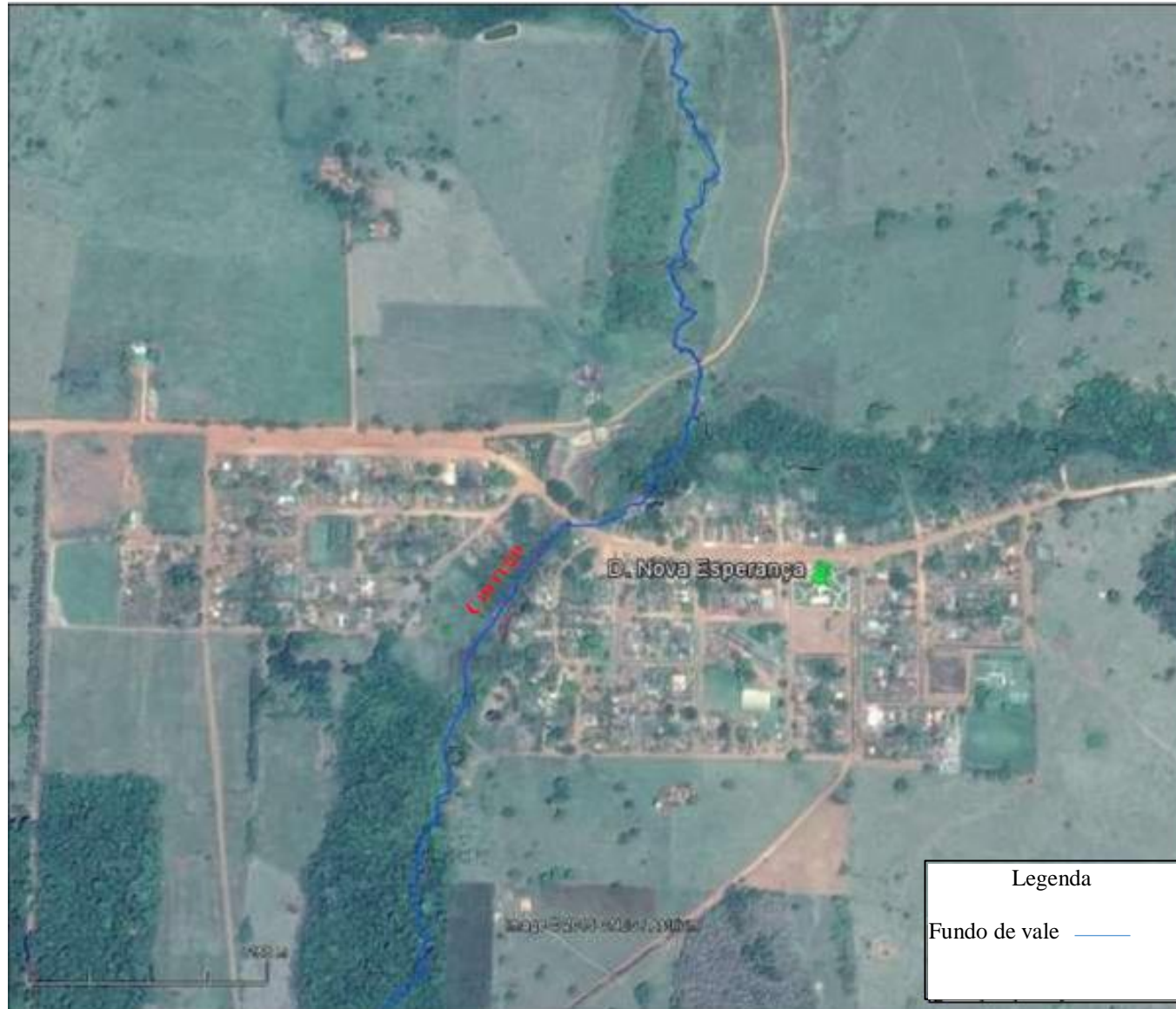
Figura 64 - Fundo de vale por onde poderá haver traçado de interceptores no Distrito Nova Esperança Fonte: Adaptado do Google (2015).
