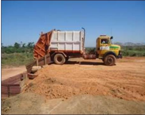
Figura 86 - Caminhão compactador para coleta convencional de resíduos sólidos Fonte: Prefeitura de Espigão do Oeste (2014).
